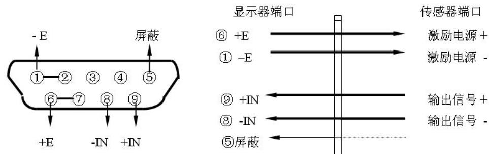
**9芯传感器接头定义：**1脚为激励电源 -；5脚为屏蔽线；6脚为激励电源 +；8脚为传感器输出信号 -；9脚为传感器输出信号 +
